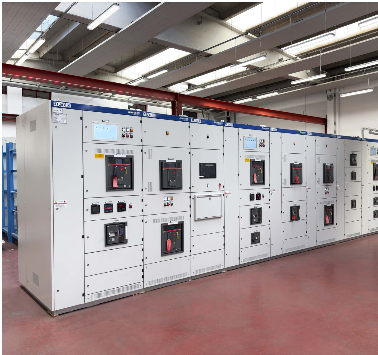
↑ Vista di insieme del quadro Power Center assemblato in officina.
